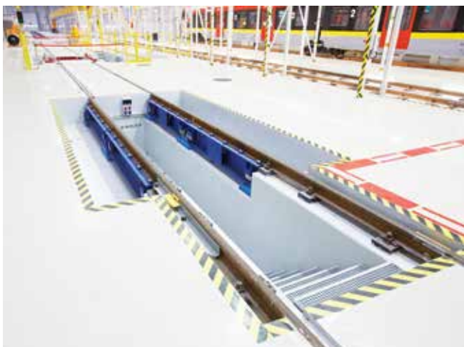
Waga do pomiaru nacisku zestawów kołowych na szynę
