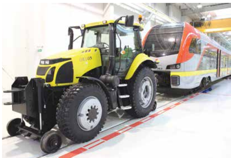
Do przemieszczania zespołów na kanałach nieelektryfikowanych wykorzystywane są ciągniki dwudrogowe. Fot. A. Masael
