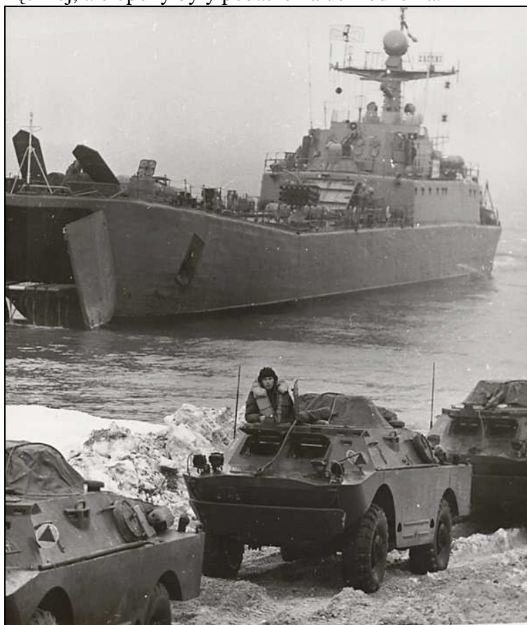
Fot. 5. Dzięki modernizacji BRDM-2 był zdolny do poruszania się w wodzie i mógł brać udział także w desantach morskich. BRDM Jednostek Obrony Wybrzeża opuszczają okręty desantowe.
