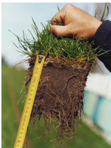
Rys. 7. Ukorzleniona warstwa z zastosowaniem systemu Aviation Fibreturf [Fibresand International, www.fibresand.com ]
