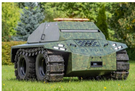
Rys. 15. Bezzałogowa, autonomiczna platforma pomiarowa do badania nośności naturalnych nawierzchni lotniskowych BIZON
