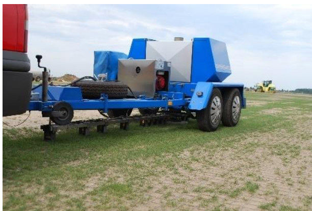
Rys. 13. Pomiar ugięć sprężystych ugięciomierzem lotniskowym HWD
