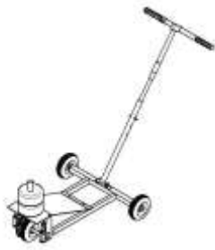
Rys. 4. Widok ręcznego testera nawierzchni lotniska trawiastego Fig. 4. Portable tester for grassy airfields
