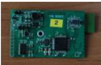
Rys. 5. Schemat oraz widok głównego modułu mikroprocesorowego systemu przesyłu danych pomiarowych. Fig. 5. Circuit diagram and a view of the main board of the microprocessor unit
