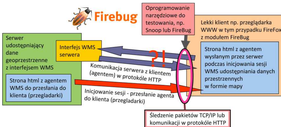
Rysunek 2.10. Schematyczne przedstawienie procesu inicjowania sesji WebMap i jej trwania, a także lokalizacja oprogramowania testującego ten proces. Opis w tekście.
