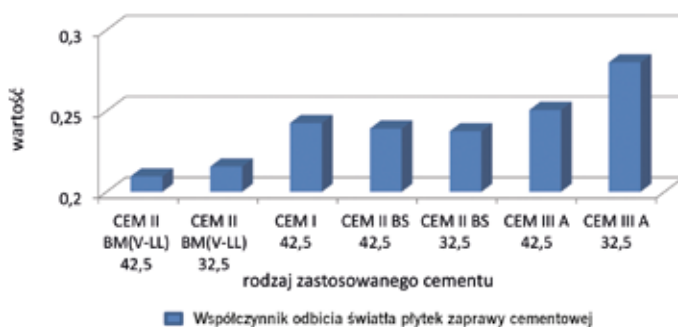
Rys. 8. Przykładowy przebieg funkcji współczynnika odbicia światła próbek zapraw cementowych dla różnych rodzajów cementu
