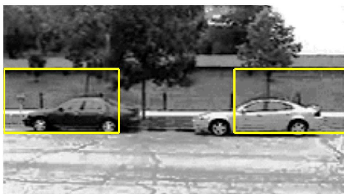
Rys. 6. Wyniki detekcji aut w przykładowym obrazie testowym uzyskane z wykorzystaniem proponowanej metody i wydzieleniu siatki podobrazów o rozmiarach 3x3.
