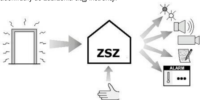
Rys. 1. Współpraca Zintegrowanego Systemu Zarządzania z systemem detekcji metali [10]
