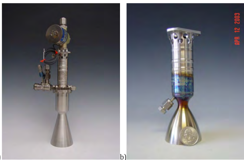
Rysunek 9. Silnik rakietowy na (a) dwuskładnikowy materiał pędny typu HTP/Nafta, [18] oraz (b) jednoskładnikowy typu HTP, [19]
