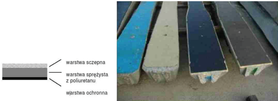
Rys. 1. USP z poliuretanu firmy Getzner {6}
