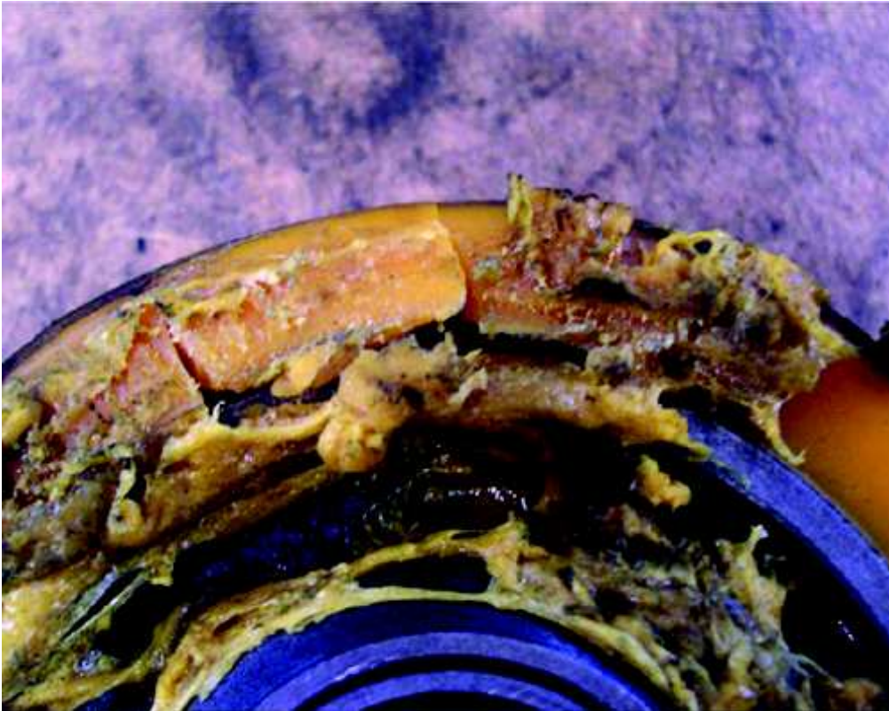
Rys.2. Przejście materiału okładziny czarnej w stan ciekły [8]
