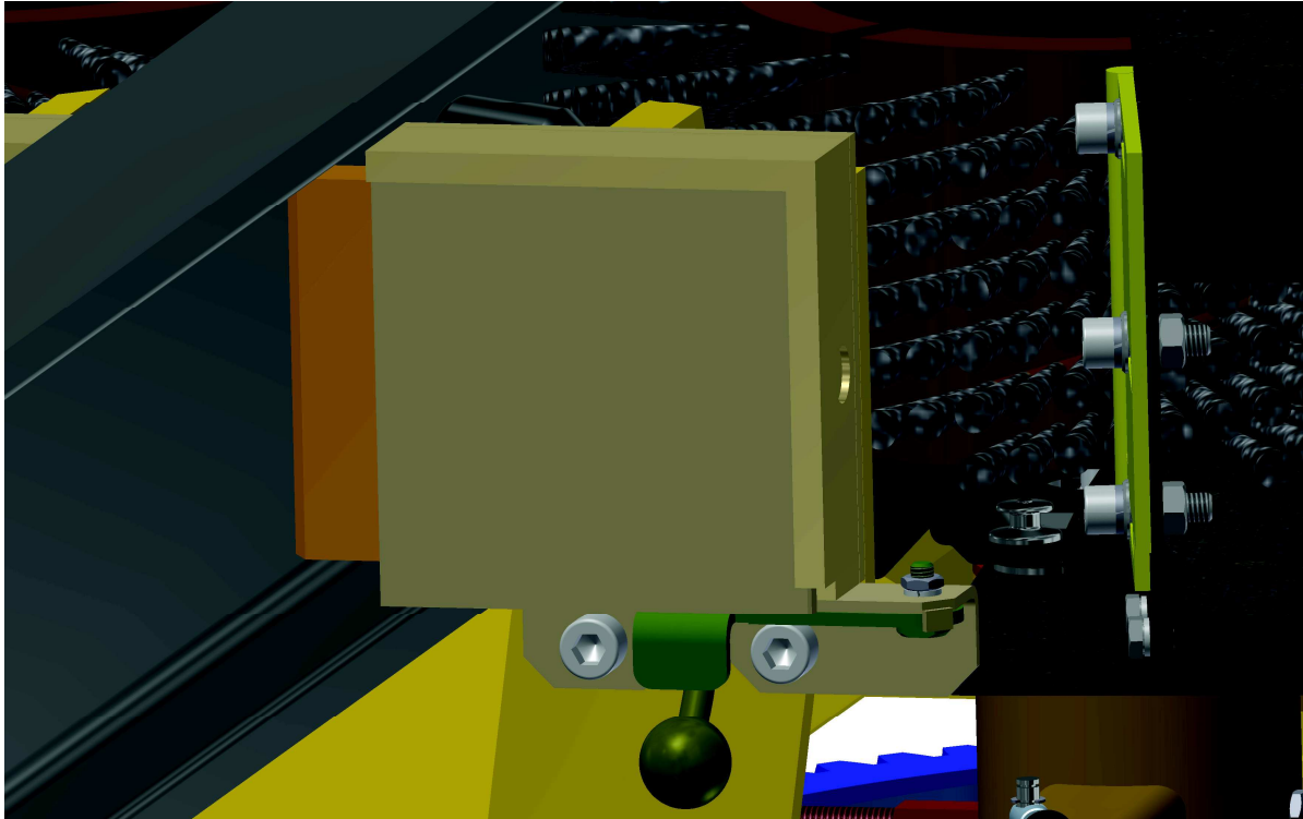
Rys. 15. Oczyszczanie środka szyny z mazi za pomocą zgarniaczy i szczotek obrotowych [opracowanie własne]
