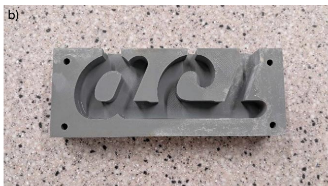
Rys. 1. Forma konkursowa: a) wymiary formy w calach [7], b) wydrukowana forma
