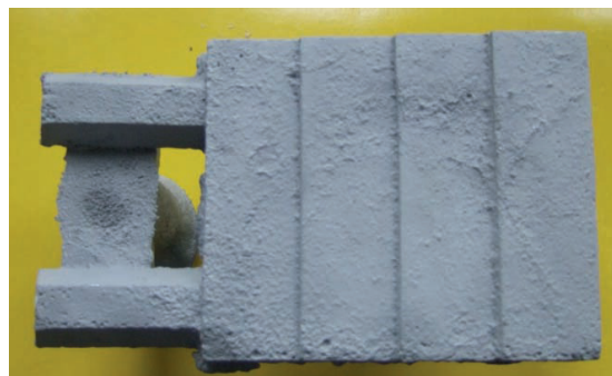
Rys. 11. Odlew wykonany z zastosowaniem technologii odlewania ablacyjnego Fig. 11. A casting made with the use of ablation technique casting
