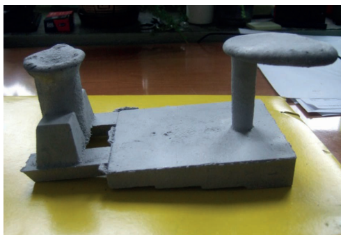
Rys. 11. Odlew wykonany z zastosowaniem technologii odlewania ablacyjnego Fig. 11. A casting made with the use of ablation technique casting
