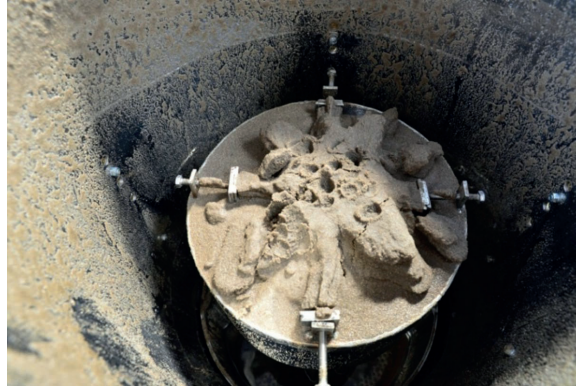
Rys. 9. Forma piaskowa rozbita w wyniku działania strumienia wody Fig. 9. A sand mould broke as a result of the operation of water jets
