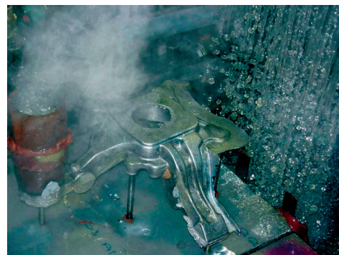
Rys. 2. Realizacja procesu odlewania ablacyjnego [4] Fig. 2. The execution of the process of ablation casting [4]
