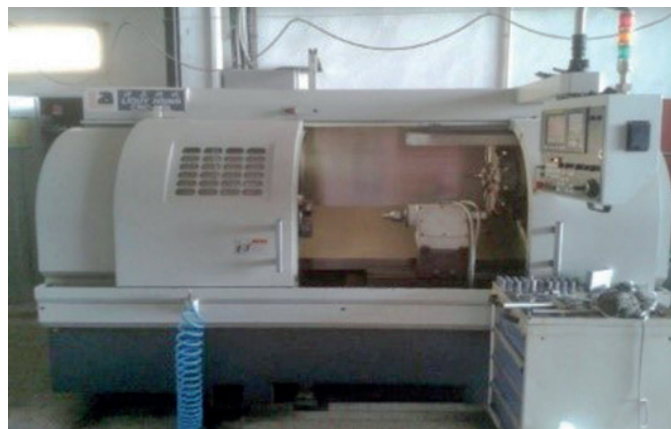
Fig. 2. Liouy Hsing GNC-450L CNC lathe
