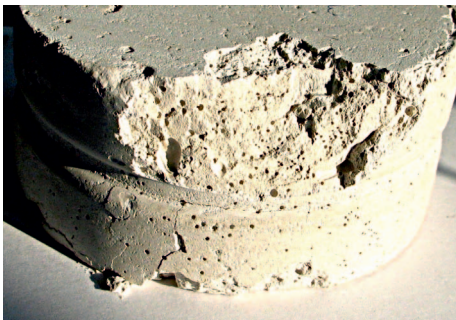
Fot. 7. Odłamek z próbki płaszczu cementowego (widoczne pustki)
