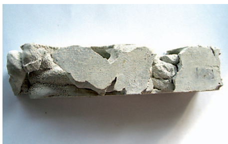
Fot. 8. Brak jednorodności w wypełnieniu uszczelnianej przestrzeni
