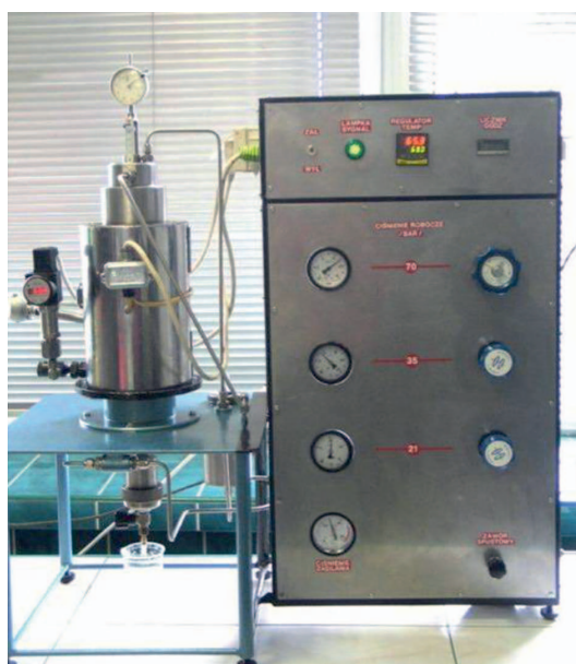
Fot. 3. Aparat do badania migracji gazu Fig. 3. The device for testing gas migration device
