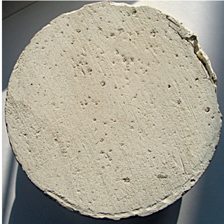
Fot. 6. Przekrój płaszczu cementowego (nieciągłości stwardniałego zaczynu)
