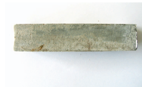
Fot. 11. Całkowite wypełnienie uszczelnianej przestrzeni
