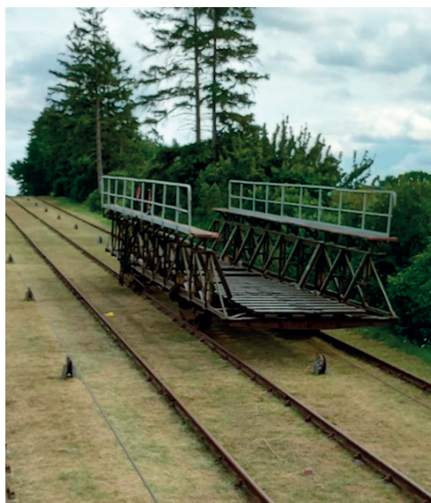
Rys. 3: Wózek transportujący w górę statek wycieczkowy białej floty (po lewej) oraz wózek niezaladowany (po prawej)
