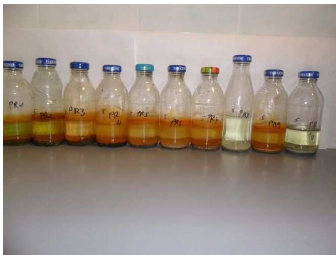
Fot. 8. Charakterystyczny kolor utlenionego żelaza w hodowlach od PR1 do PR7 oraz PR 9.
