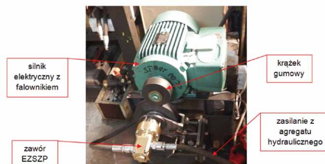
Rys. 9. Zawór EZSZP zabudowany na stanowisku badawczym [5]
