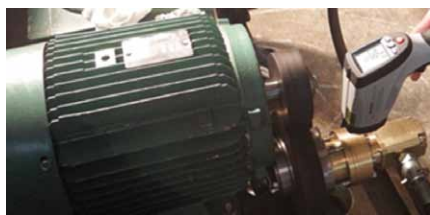
Rys. 10. Pomiar temperatury na korpusie zaworu [5]
