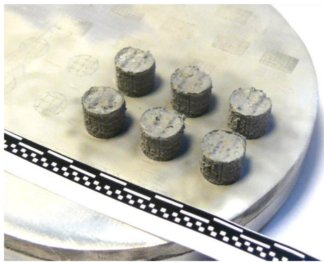
Rys. 1. Wyprodukowane w technologii SLM próbki walcowe do przeprowadzenia hodowli
