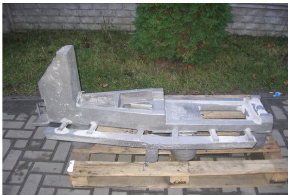
Rys. 4. Odlew z GJS 400-15 podstawy stacji o masie 102 kg.
