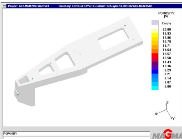
Rys. 2. Rozkład prognozowanej porowatości powyżej 5% dla składów S1 i S3 przedstawionych w tabeli nr 1
