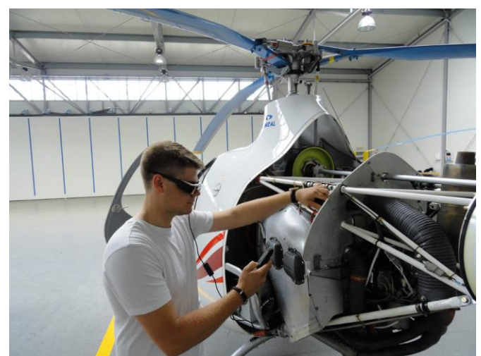
Fot. 5. Wykonywanie przeglądu w okularach Moverio BT-200
