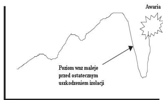
Rys. 7. Krzywa życia układu izolacyjnego dla przykładowej maszyny elektrycznej według firmy CUTLER-HAMMER [3, 7]
