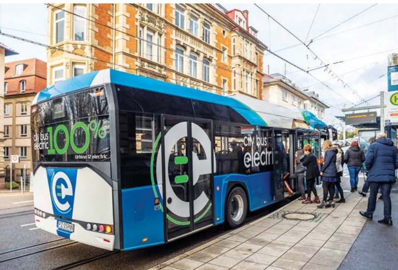
Przy dobrze wykonanej infrastrukturze przystankowej zajęcie miejsca w autobusie niskopodłogowym przestaje być barierą dla osób o ograniczonej mobilności. Na fot. Solaris Urbino 12 electric w Dreźnie. Fot. Solaris
