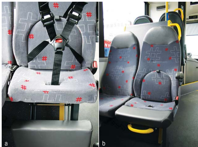
W autobusie Solaris Urbino: a) fotelik do przewozu dziecka z pasami bezpieczeństwa b) po złożeniu fotelika dziecięcego uzyskuje się miejsce siedzące dla osoby dorosłej. Fot. Solaris.
