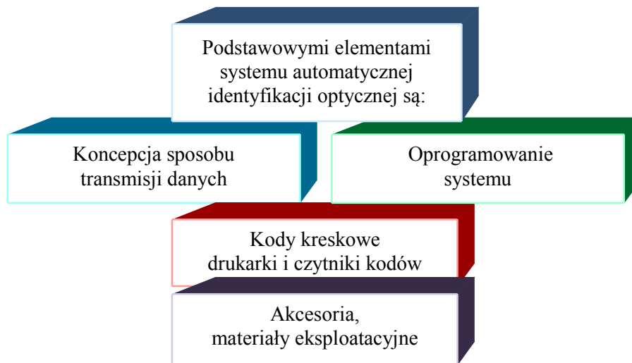
Rys. 3. Podstawowe elementy systemu automatycznej identyfikacji optycznej
