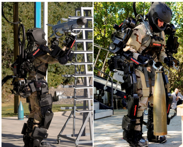
Rys. 3. Egzoszkielec XOS2 podczas testów [16]
