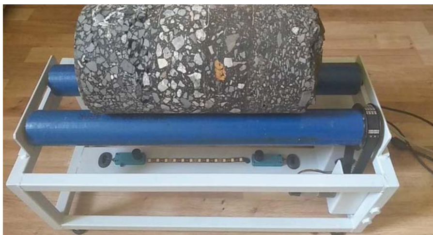
Rys. 8. Urządzenie z próbką walcową umieszczoną na rolkach
