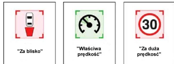
Rys. 3.7. Przekazywanie wskazówek kierowcy przez system Foot-LITE [12]
