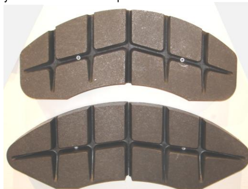
Rys. 2. Widok okładziny cierniej z materiału organicznego z widocznymi rowkami dylatacyjnymi
