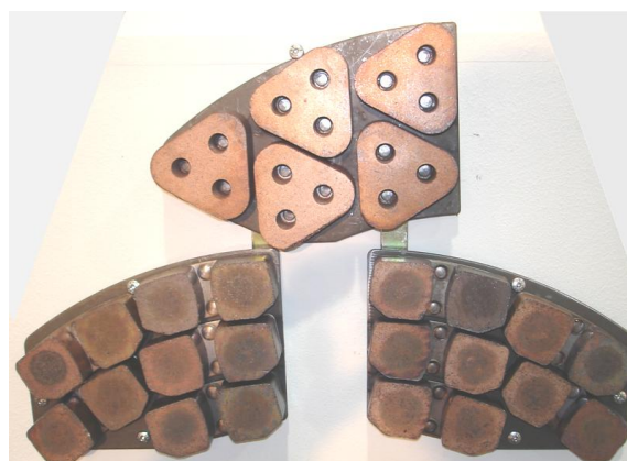
Rys. 3. Widok okładziny cierniej z materiału spiekanego
