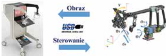
Rysunek 6. Topologia optymalnego połączenia zdalnego robot chirurgiczny – konsola operatora
