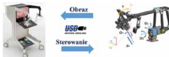
Rysunek 9. Sprzęt testowy używany po stronie FRK – konsola sterowania z 2 zadajnikami ruchu, specjalistycznym oprogramowaniem i robot Robin Heart Tele (dla testów teletransmisji całość komunikacji z komputerem realizowana przez protokoły USB)
