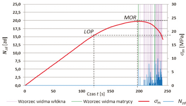
Rys. 6. Przebieg tempa zdarzeń N_{zd} , naprężeń zginających \sigma_m w funkcji czasu, dla płyty poddanej oddziaływaniu ognia wraz z naniesioną identyfikacją wzorcowych charakterystyk widmowych [19]
