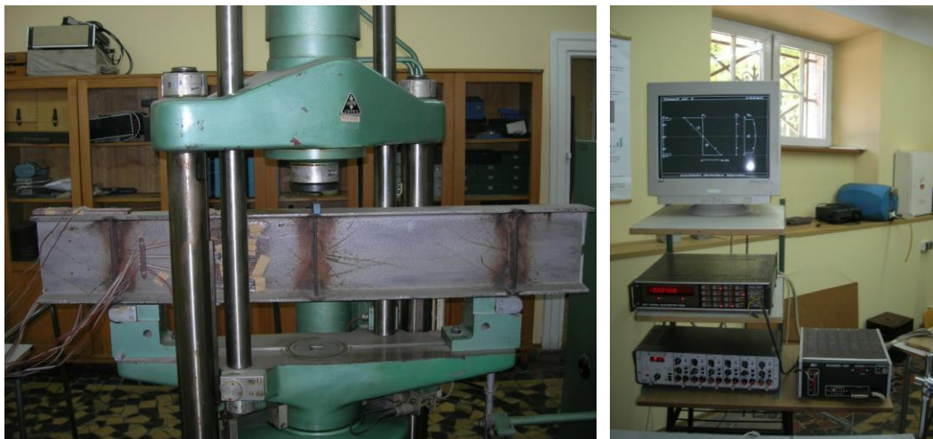
Fot. 7. Blachownica stalowa: a) widok blachownicy, b) wizualizacja wykresów naprężeń
