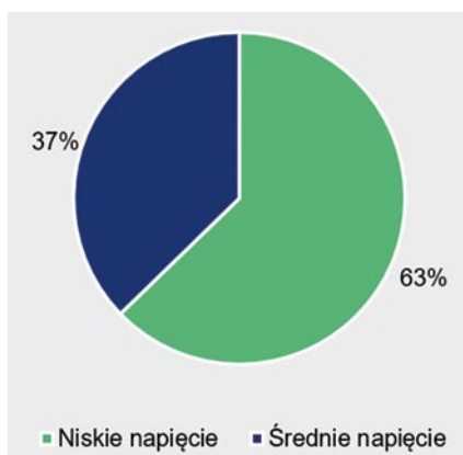
Rys. 3. Zależność uszkodzonych sieci elektroenergetycznych od ich napięcia
