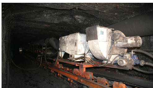
Rys. 6. Przykład odpylacza mokrego HCN z wentylatorem promieniowym [3] Fig. 6. An example of a HCN wet dust collector with a radial fan [3]
