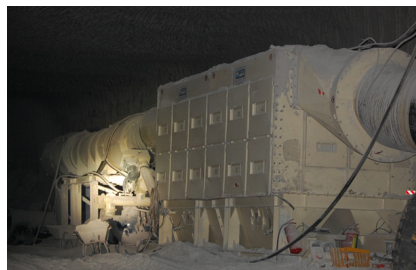
Rys. 13. Widok odpylacza suchego HTKK w komorze solnej w ZG „Polkowice-Sieroszowice” [3] Fig. 13. View of the HTKK dry deduster in the salt chamber at the "Polkowice-Sieroszowice" mine [3]
