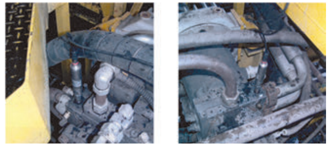
Punkt nr 5 – pompa lewej gaśienicy Punkt nr 6 – pompa prawej gaśienicy Rys. 4. Punkty pomiaru ciśnienia w układzie jazdy [2]
