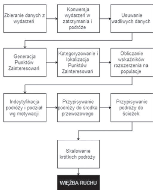
Rys. 1. Uproszczony proces budowy więzby z danych telefonów komórkowych źródło: [4]
