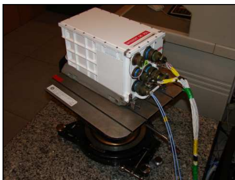
Fot. 5. Widok centrali INS/GPS TOTEM-3000 na stole przechylnym typu KPA-5 [7]
