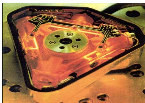
Fot. 8. Widok wnętrza giroskopu laserowego systemu INS/GPS TOTEM-3000 [4]
