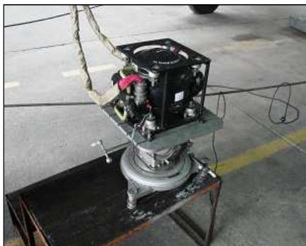
Fot. 3. Widok pionu kursowego KW-1 układu IKW-8 na stole przechylnym KPA-5 [7]
