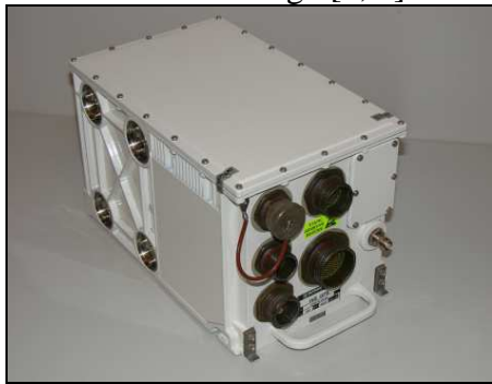
Fot. 1. Widok złączy zasilania i sygnałowych centrali INS/GPS TOTEM-3000 [4]
