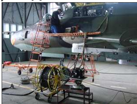
Fot. 9. Widok elementów układu IKW-8 w czasie badań na samolocie Su-22 [7]
