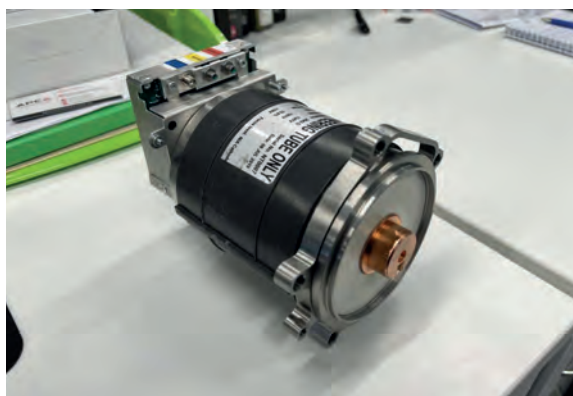
Ryc. 13 Emiter elektronów na bazie CNT firmy Micro-X Komercyjna lampa dla potrzeb medycyny ww. firmy (40–120 kV, 90 mAmax, maksymalny czas ekspozycji 1500 ms, ciągła moc anody 28 W, masa 2,35 kg) Źródło: Archiwum własne.
