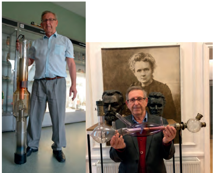
Ryc. 4 Z lampą Coolidge'a SRT-4 (400 kV, 15 mA) w Muzeum Lamp Rentgenowskich Politechniki Opolskiej oraz z lampą Lilienfelda w Muzeum Marii Skłodowskiej-Curie w Warszawie Źródło: Archiwum własne.
