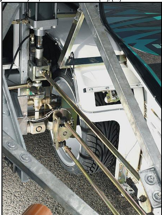
Rys. 12. Zawieszenie koła badanego i część toru pomiarowego w przyczepie FKFS [11], [14].
