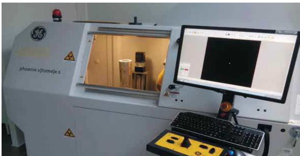
Rys. 4. Dzięki wysokoenergetycznej rentgenowskiej lampie microfocus, system GE phoenix v|tome|x s240 CT szczególnie nadaje się do penetracji materiałów wysokiego tłumienia
