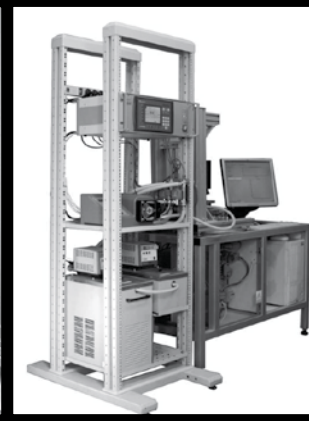
RYS. 2. Widok ogólny symulatora żucia. FIG. 2. View of mastication simulator.
