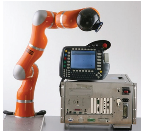
Rysunek 2. Robot KUKA LWR 4+ ze sterownikiem i panelem KCP (KUKA Control Panel) [11]
