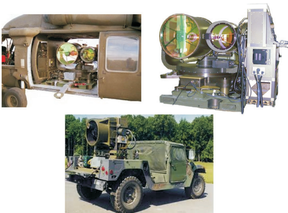
Rys. 5. System detekcji skażeń biologicznych dalekiego zasięgu (LR-BSDS): w śmigłowcu, na platformie samochodowej [23]
