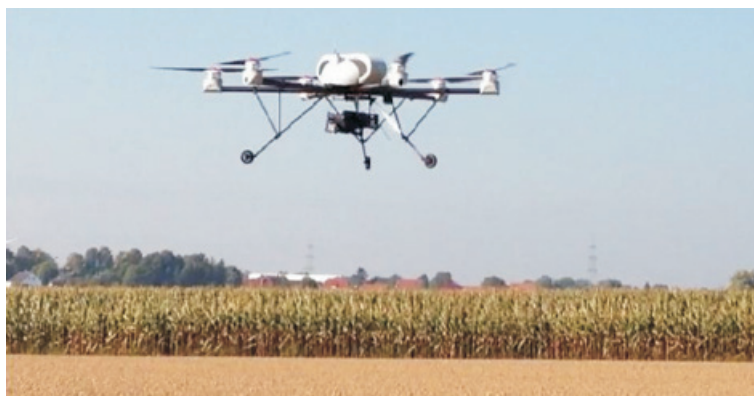
Rys. 13. Dron z detektorem do rozpoznania skażeń: powierzchnia obszaru obserwacji — 450 km 2 ; czas pełnego skanowania — regulowany od 10 s, generowanie sygnału o skażeniach — w czasie rzeczywistym; generowanie współrzędnych obłoku — w czasie rzeczywistym; kąty pomiaru: w poziomie — 360°; w pionie od -30° do +90°; prędkość kątowna skanowania — regulowana; błąd pomiaru (odległości i głębokości obłoku): \pm 2 m; obsługa: jedna osoba [31]
