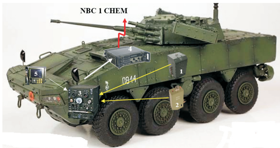
Rys. 12. Wyposażenie KTO „Rosomak” w elementy do rozpoznania skażeń (zakażeń): 1) automatyczny sygnalizator skażeń chemicznych i promieniotwórczych: z funkcją identyfikacji środka skażającego, z dwiema sondami radiometrycznymi (jedna umieszczona w przedziale mechanika-kierowcy, druga na zewnątrz transportera), blok wykrywania skażeń TSC i bliskich wybuchów jądrowych, z interfejsem i/lub oprogramowaniem umożliwiającym pracę w zautomatyzowanych systemach wykrywania skażeń; 2) automatyczny sygnalizator skażeń biologicznych z interfejsem i/lub oprogramowaniem umożliwiającym pracę w zautomatyzowanych systemach wykrywania skażeń; 3) integrator z kryptokomputerem z oprogramowaniem umożliwiającym zautomatyzowaną integrację zbieranych danych ze specjalistycznego sprzętu pomiarowego w trakcie tworzenia meldunków i tworzenie meldunków, których postać i zawartość jest zgodna z dokumentami normatywnymi NATO (DT-3.8.1.5 (F)) a także ich transmisję drogą radiową; 4) cyfrowa radiostacja pokładowa transportera; 5) system nawigacji wspomagany GPS
