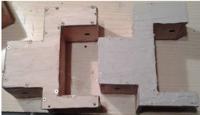
Rys. 4. Moduły środkowe - po lewej przed nałożeniem silikonu, po prawej po wykonaniu powłoki
