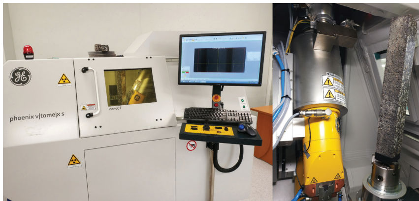
Rys. 2. Mikrotomograf phoenix oraz próbka na stanowisku badawczym
