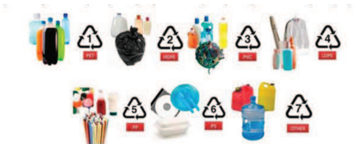
Rys. 6. Oznaczenie tworzyw polimerowych przeznaczonych do recyklingu [31]
