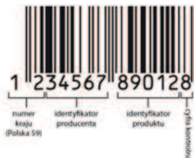
Rys. 2. Budowa 13 – sto cyfrowego kodu kreskowego EAN [24]
