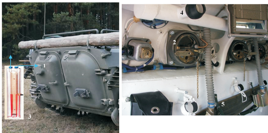
Rys. 4. Metoda określenia szczelności BWP: 1 — osłonięty luk strzelniczy na zewnątrz transportera; 2 — widok luku wewnątrz transportera; 3 — manometr z PKM; 4 — wylot z UFW; 5 — odciąg gazów prochowych [opracowanie własne]
