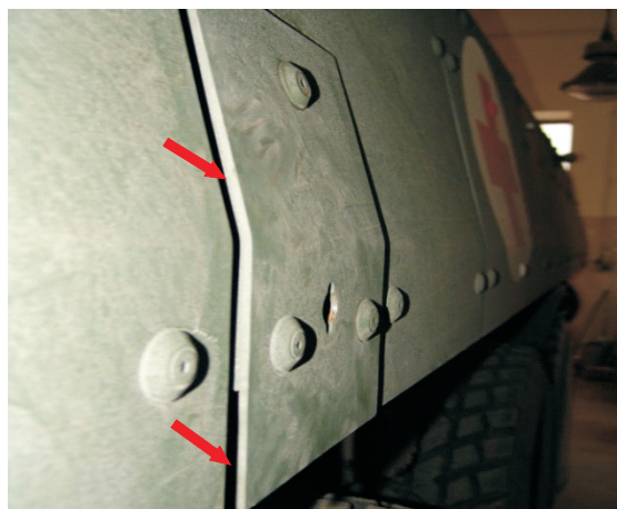
Rys. 9. Widok odstającej płyty osłony zasilania zewnętrznego [źródło: ze zbiorów WIChiR]
