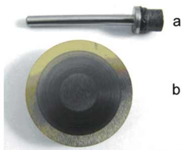
Rys. 3. a – próbka (trzcień); b – przeciwpróbka (krążek)
