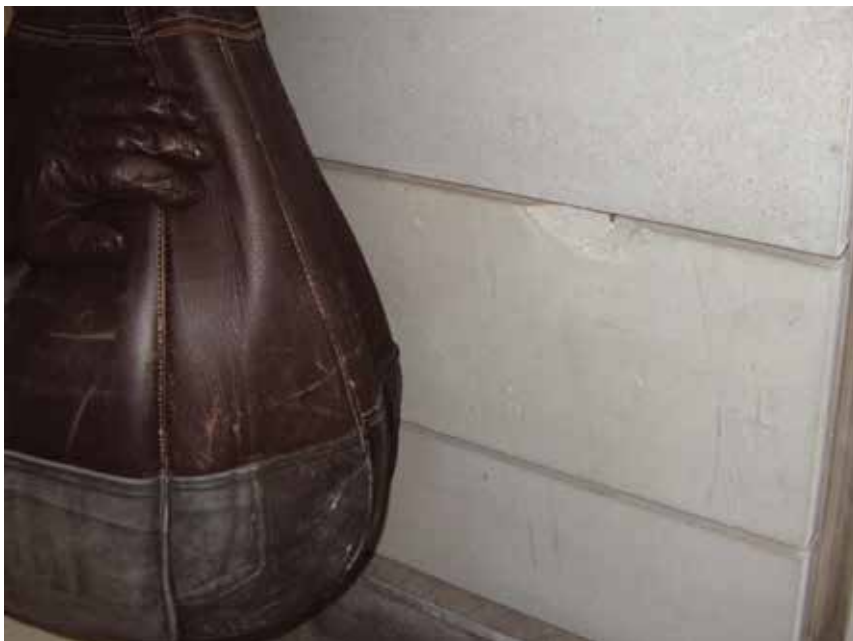
Fot. 6. Wynik badania odporności na uderzenie elewacji wentylowanej: system elewacyjny nie może być stosowany w miejscach dostępnych dla ludzi; źródło: fotografia autorów
