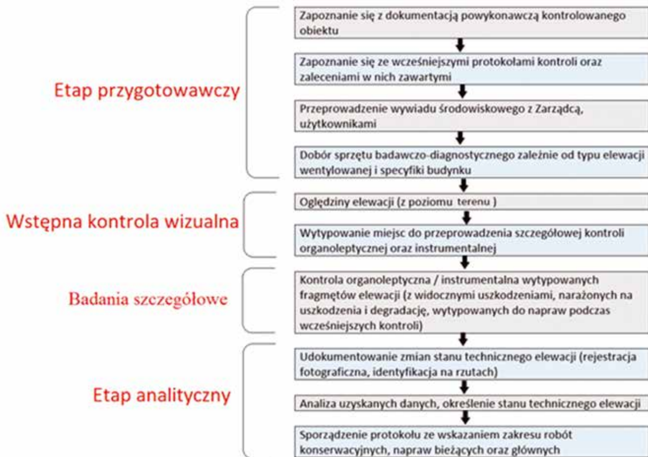
Rys. 2. Etapy badania stanu technicznego elewacji wentylowanych; źródło: [5]
