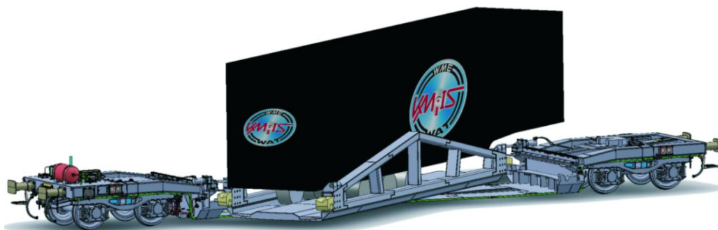
Rys. 14. Platforma kolejowa w pozycji otwartej (po załadowaniu naczepy)
