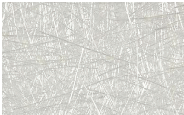
Rys. 1. Materiały wzmacniające: a) mata szklana, b) tkanina lniana Fig. 1. Reinforcing materials: a) glass fiber mat, b) flax fabric
